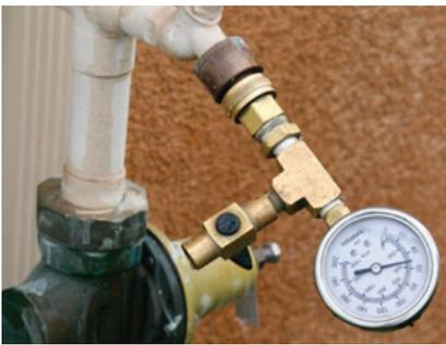
Usando un medidor de presión, puede medir su presión del agua en grifos para manguera en varias áreas, con y sin el agua fluyendo dentro de la casa. Una disminución de cinco (5) libras de presión generalmente es aceptable, más de eso puede ser síntoma de un problema con la presión del agua.
