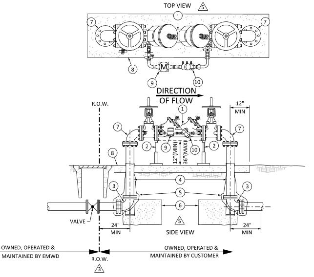
NOTE: ALL DI JOINTS SHALL BE RESTRAIN TYPE
